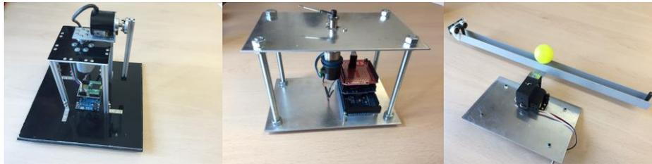
**Figura 2.** Fotografías de algunas de las maquetas realizadas (péndulo rotativo, servo-motor y bola en barra).
