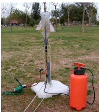
**Figura 1.** Plataforma de lanzamiento de cohetes de agua, de elaboración casera
