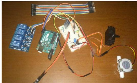
**Figura 8.** Circuito de control de la plataforma de lanzamiento de cohetes de agua, SATURNIA
